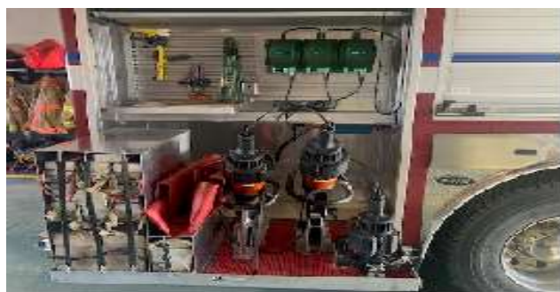
Source : Service de sécurité incendie Nouvelles pinces de désincarcération à batterie
